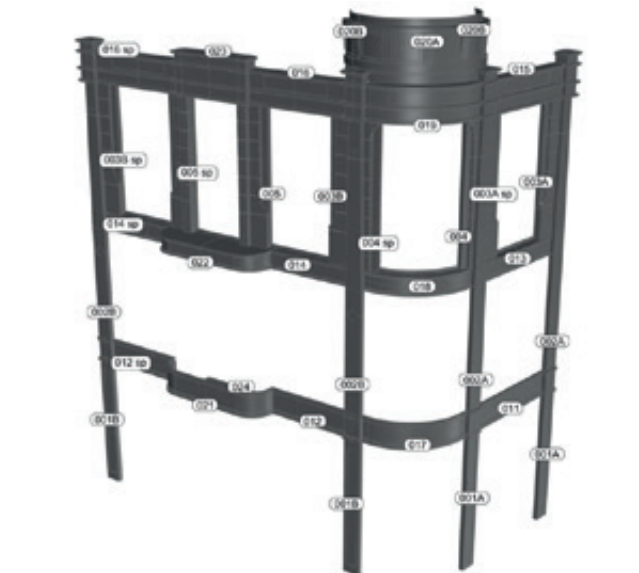
Trójwymiarowy model elementów fasadowych do produkcji
